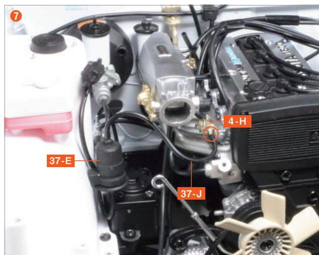
7 把第37期中安裝在燃油濾清器 37-E 上的燃油管 37-J 插入燃油壓力調節器 4-H 的突起部分。
