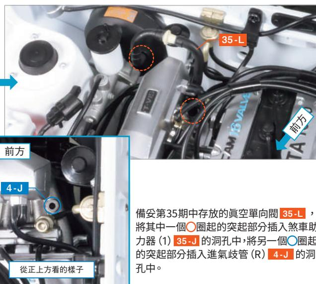
11 備妥第35期中存放的真空單向閥 35-L，將其中一個○圈起的突起部分插入煞車助力器 (1) 35-J 的洞孔中，將另一個○圈起的突起部分插入進氣歧管 (R) 4-J 的洞孔中。
