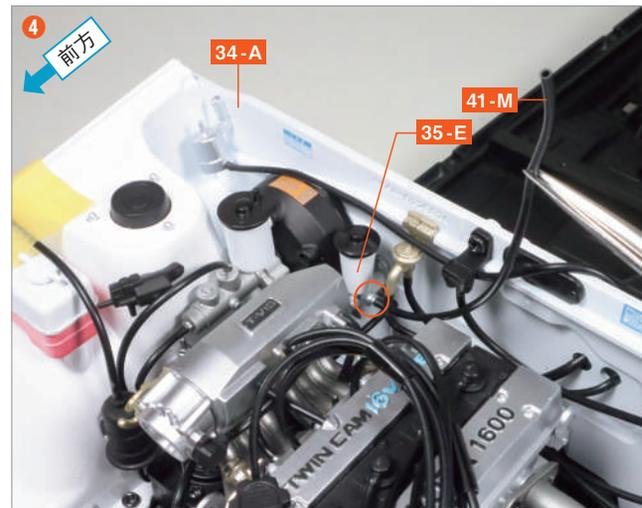
把第 41 期中安裝在離合器主缸 35-E 上的離合器管 41-M，從引擎和艙壁隔板 34-A 之間拉出至底盤的背面側。
