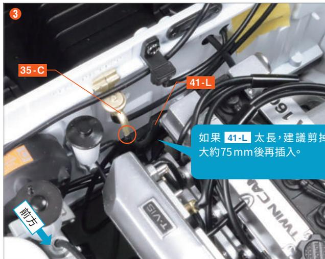
將 41-L 插入加熱器水閥 35-C 的前端突起部分。
